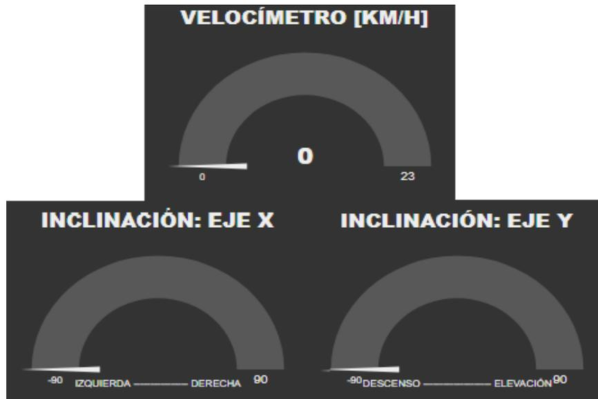
El velocímetro recibe los valores provenientes de la lectura del encoder, los cuales son transmitidos a través del protocolo MQTT bajo el topic **Velocidad**. En la ilustración 42, se muestra la conexión entre el valor recibido y el nodo **Dashboard** en la aplicación Node-RED
