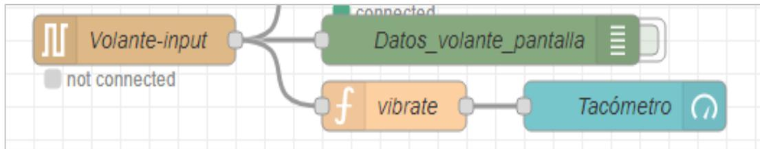
Los valores del eje Z, al igual que los de los ejes X y Y, son obtenidos del giroscopio y transmitidos a través del protocolo MQTT bajo el topic eje\_z. En la ilustración 46 se muestra la conexión correspondiente.
