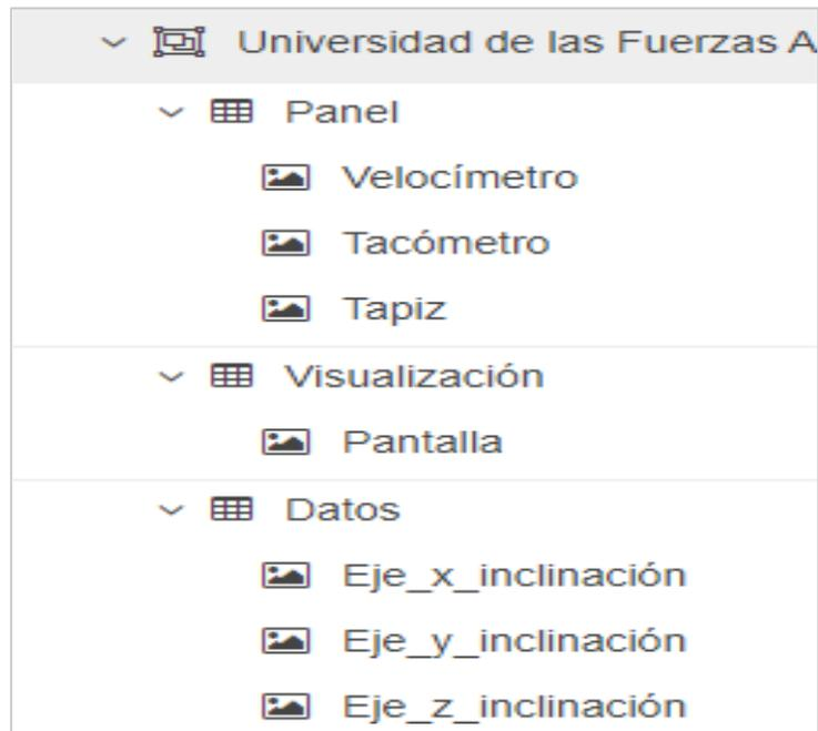
La información recibida de los sensores se conecta a diferentes nodos de **Dashboard**, los cuales permiten la interacción con el usuario, ya que su apariencia y valores varían según los datos numéricos recibidos. Un ejemplo de esto son el velocímetro y los ejes de inclinación, los cuales utilizan un nodo denominado **gauge**. En la **Figura 45** se muestra el esquema del velocímetro y las inclinaciones de los ejes X y Y, respectivamente.
