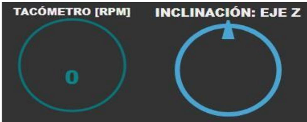
El tacómetro recibe los valores que corresponden al grado de presión ejercido en los pedales, donde el valor mínimo es 0 cuando no hay presión, y el valor máximo es 8 cuando se alcanza la presión total. Este valor es recibido a través del puerto serial correspondiente que conecta el volante con el computador.
