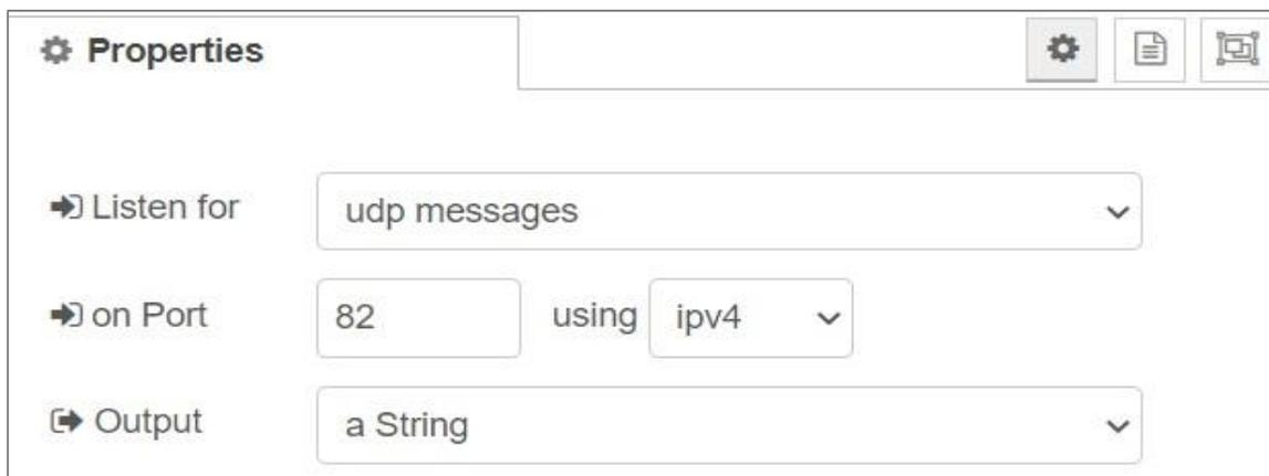
Para el funcionamiento de la recepción, es necesario configurar tres parámetros clave en el nodo UDP In:
